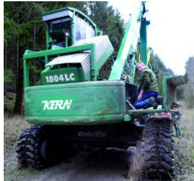
Beim Vergleich der Heckansicht des Hannimax Soft (oben) mit einem normalen Bagger (oben rechts) wird das bessere Blickfeld durch die schräg nach hinten fahrbare Kabine deutlich. Der rote Kreis im oberen Bild kennzeichnet die Lage des Auspuff-Endrohres. Im Bild rechts demonstriert Johann Burkhardt die leichte Zugänglichkeit von Motor und Kühler. Erreicht wird dies durch die abklappbare und begehbare Seitenrutsche.
