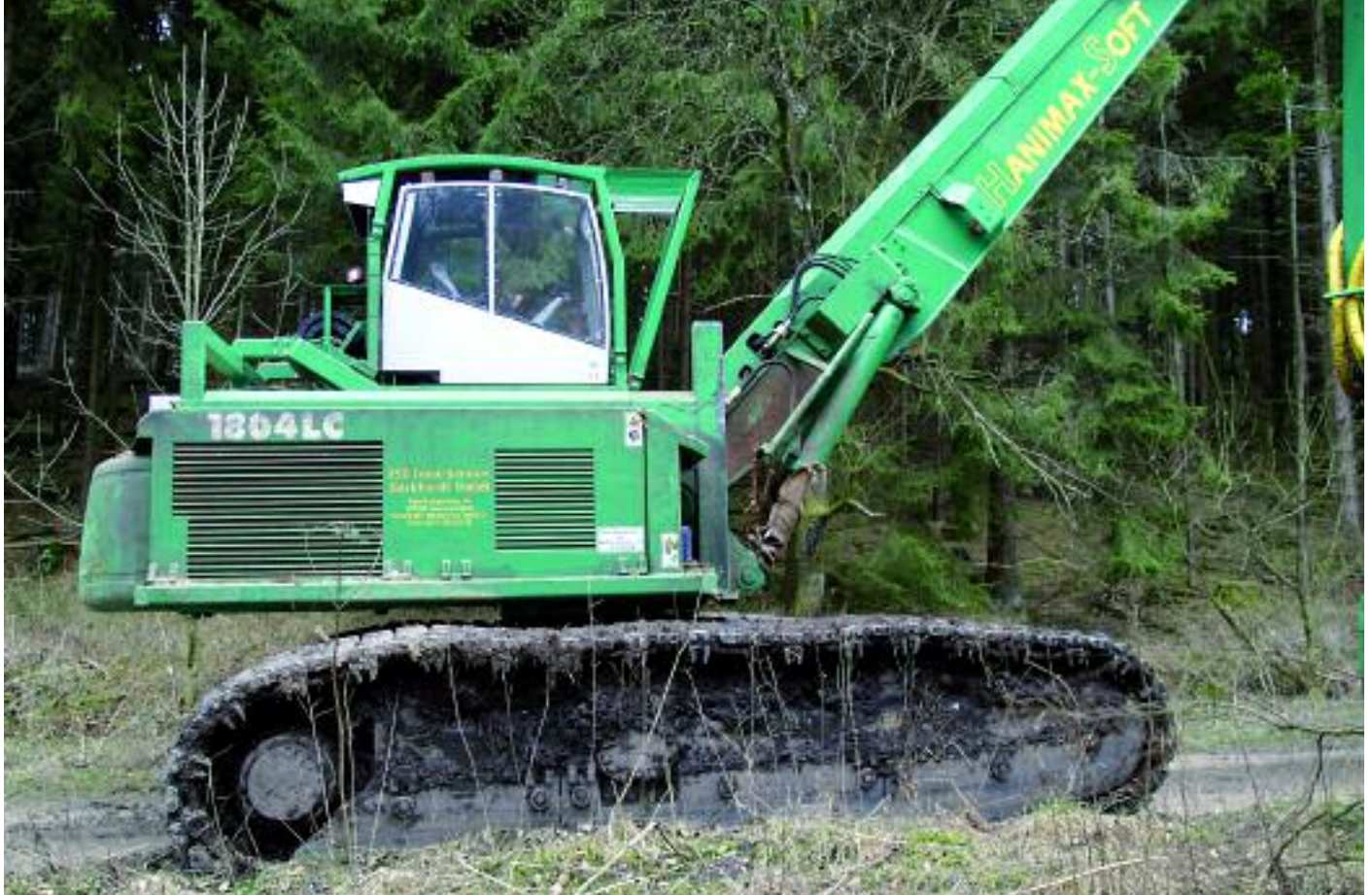
Oben: Hier kann man gut das weit vorne angebrachte Fahrwerk erkennen, das für einen festen Stand sorgt. Links: Xavier Leinsle (links) und Johann Burkhardt sind die Väter des Hannimax Soft. Rechts: Das Aggregat stammt von Keto, der Sägekasten und andere Gimmicks sind Eigenbau.
